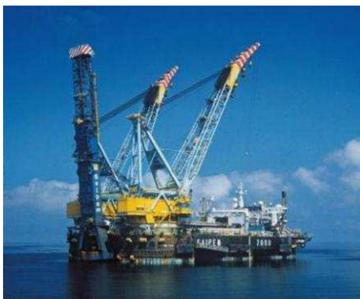
Фигура 3.6 Типичен плавателен съд за J-образно полагане в дълбоки води
