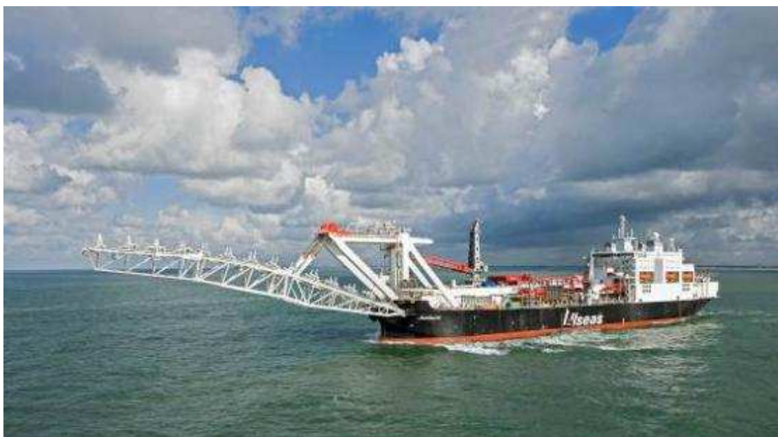
Фигура 3.4 Типичен плавателен съд за S-образно полагане на междинна дълбочина на водата
