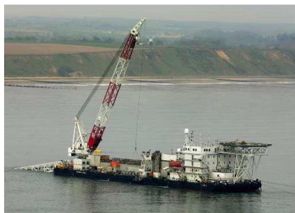
Фигура 3.9 Типичен плавателен съд за S-образно полагане в плитки води
