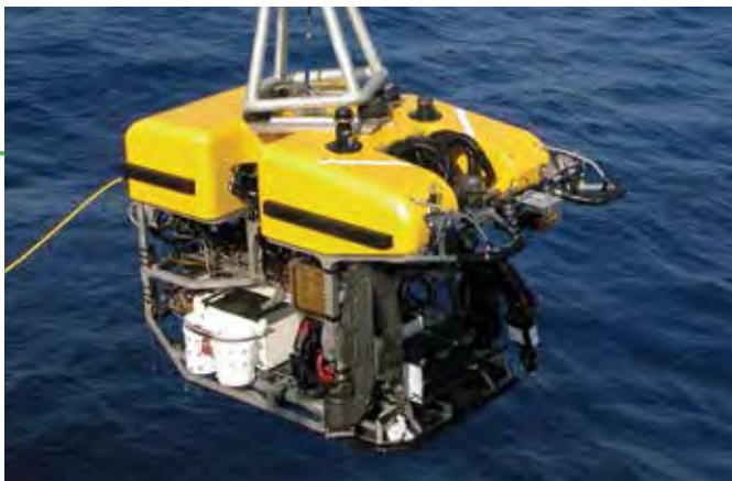
Дистанционно управляеми устройства, използвани за проверка на подводното тръбопровода
